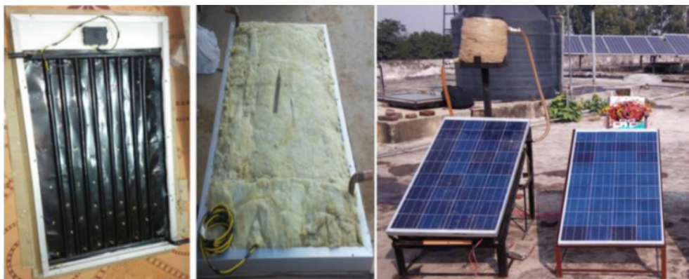
Рисунок 3.23 – Солнечная панель с комбинированным охлаждением [124]
