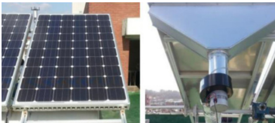
Рисунок 3.19 - Солнечная панель с системой принудительного воздушного охлаждения [114]
