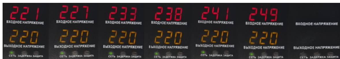
Рисунок 4.17 – Динамика увеличения напряжения с помощью ЛАТР
