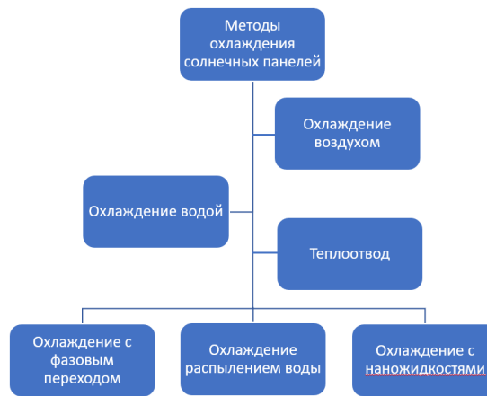
Рисунок 3.18 – Методы охлаждения солнечных панелей
